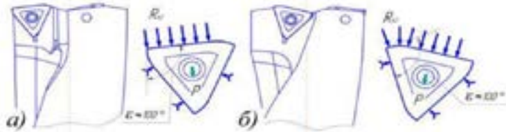
Рисунок 2 – Схематичное изображение базирования, нагружения и закрепления режущих пластин новой формы: а – периферийной и б – центральной в корпусе сборного сверла
