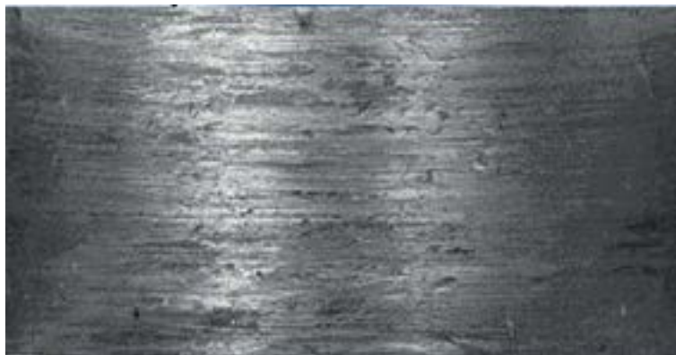
Сурет 1 – Машина механизмдерінің жұмыс органдарының абразивтік тозуы
